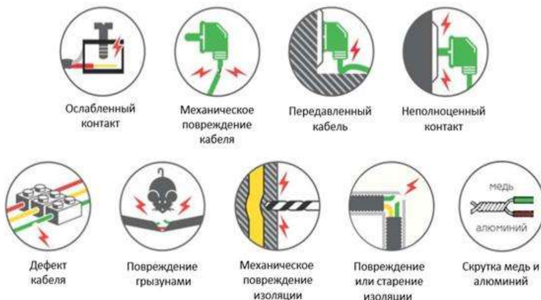
Рисунок 6. Возможные причины искрения в электропроводке
