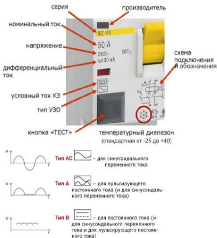
Рисунок 5. Маркировка УДТ
