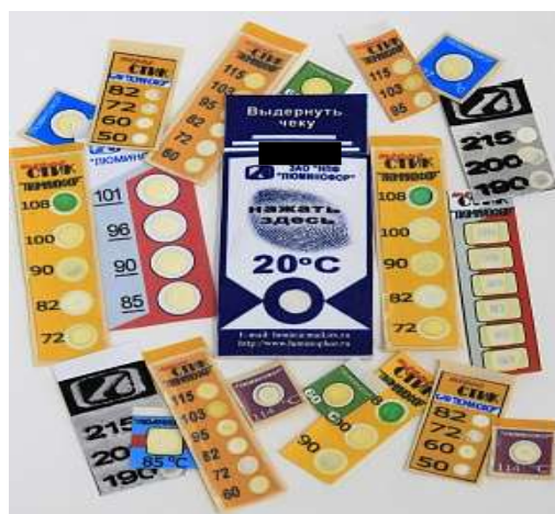
Рисунок 13. Примеры термоиндикаторных наклеек различных производителей
