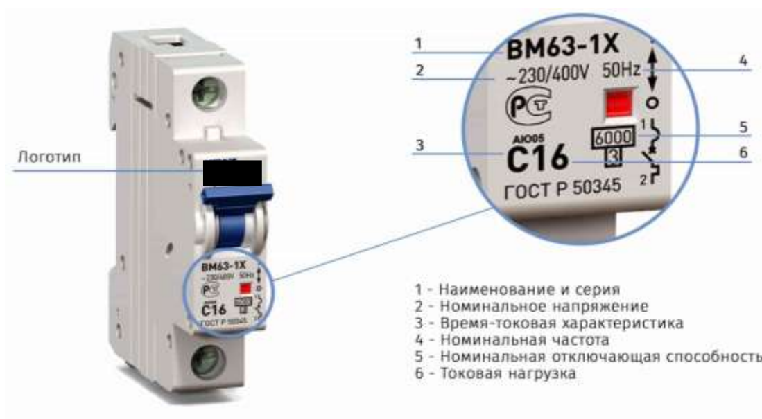
Рисунок 2. Пример маркировки АВ
